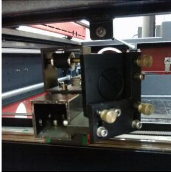
*FIGURA 3: Tornillos para el ajuste del Espejo X.*
